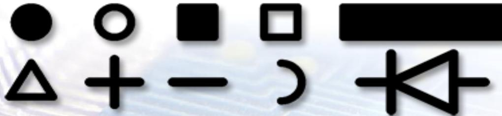
Die **bevorzugte** Position für eine Polaritätsmarkierung ist das Ende des Bauteiles am Pad und dort so weit wie möglich von der Bauteilkante entfernt. Dadurch wird die visuelle Montageüberprüfung vereinfacht, egal wohin sich das Bauteil während des Reflow Prozesses hinbewegt: der Punkt wird immer sichtbar sein.
